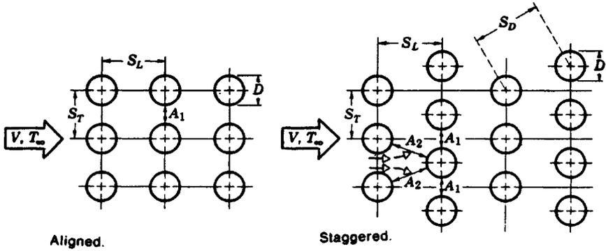
Fig. 43.12 Tube arrangement.
